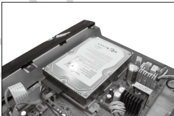
Фото установленного 3,5 HDD
